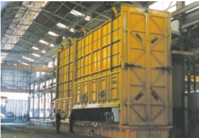
Campana captación humos
